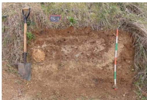
FIGURA 7. Perfil FAL-1. Se aprecia la heterogeneidad del Tecnosol formado como mínimo por la mezcla de dos tipos de tierras (la de color rojizo descrita como material 1, y la blanquecina como material 2). Autor: V. Carabassa.
