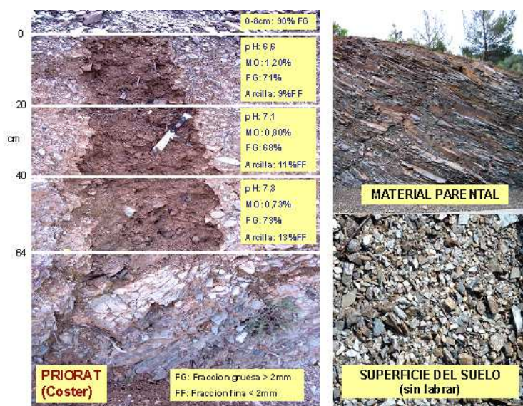
FIGURA 3. Perfil del suelo, material parental (pizarra) y superficie del suelo en una tierra sim labrar en coster del Priorat geológico (% Arcilla: % de la fracción <2mm). Fuente: autores.
