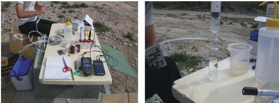
FIGURA 4. Toma de muestras y determinaciones in situ de algunos parámetros geoquímicos.
