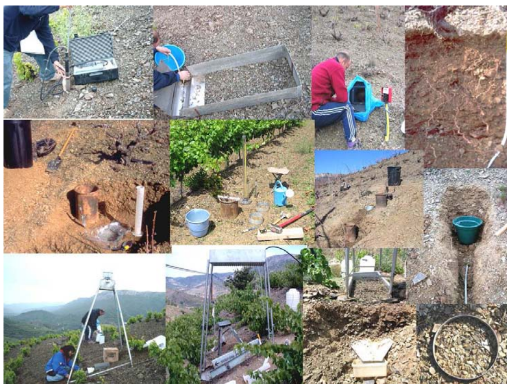
FIGURA 13. Algunas determinaciones de propiedades físicas e hidrológicas de los suelos a nivel de campo. Fuente: autores.
