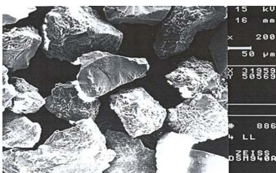
FIGURA 13. Arenas angulosas de la muestra 4-LL, de origen fluvial. Algunas aristas están afectadas por disolución. Fotografía RM. Poch.
