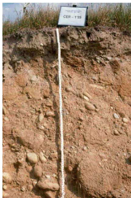
FIGURA 21. Detalle del perfil CER-1'99 donde se aprecia claramente la meteorización del granito y situado a unos 500 m del perfil CER'-99-2. Autor: RM Poch.
