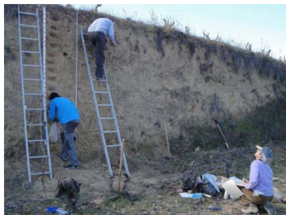
FIGURA 6. Vista del corte del Coll de les Obagues (els Guiamets) durante las labores de saneamiento y preparación, previas a la toma de muestras para el análisis detallado del perfil sedimentológico y edáfico. Fotografía: J.C. Balasch.
