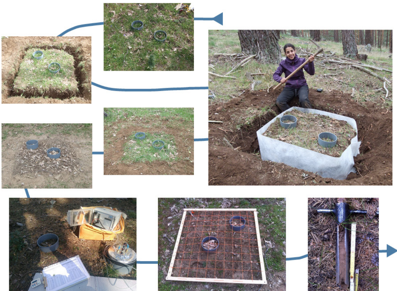
Detalle de las etapas de implementación del experimento de exclusión radical, medición de flujos respiratorios y muestreo de suelo.
